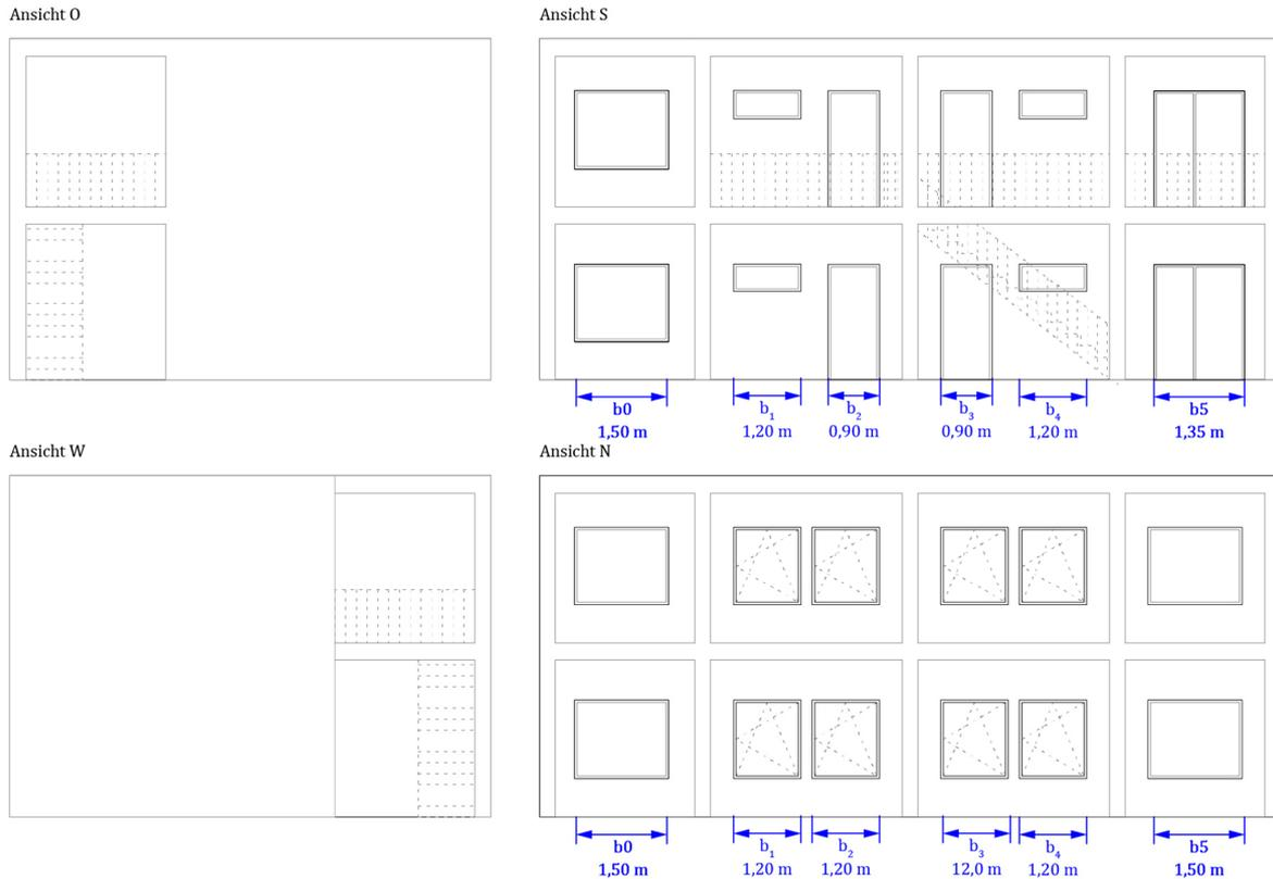
Abbildung 16: Ermittlung aller Öffnungsbreiten an jeder Gebäudefassade
